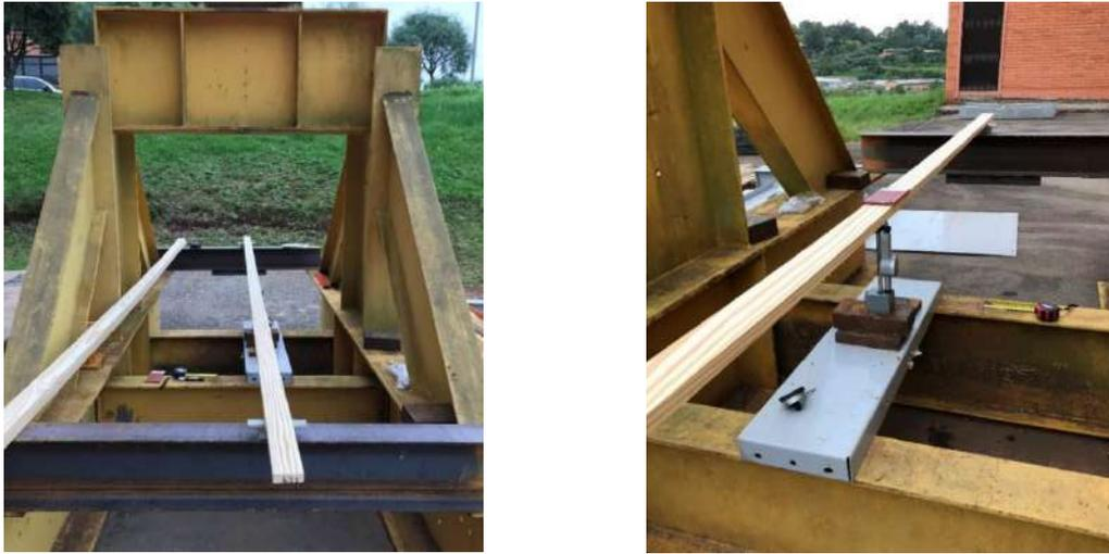
Figura 2 – Realização do ensaio de determinação da rigidez à flexão das lâminas.
