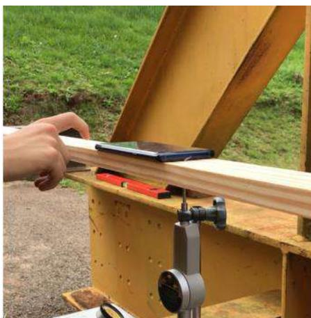
Figura 3 – Frequência fundamental das lâminas, medida com Smartphone.
