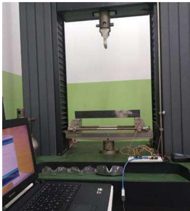
A coleta de dados foi realizada através de placa de aquisição de dados, calibrada com osciloscópio, ainda, a realização de três ensaio de tração para aferição do módulo de elasticidade do material, segundo a norma da ASTM E 8M-04, resultando em um módulo de elasticidade de 215,947 GPa. Assim, obtemos os dados, conforme o valor da força aplicada em função do tempo, sendo necessário adotar um carregamento crescente devido a variação entre os ensaios.
